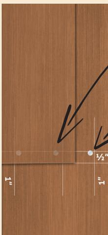
Use 2 sujetadores para shingles de 4", 5", y 6" de ancho.
